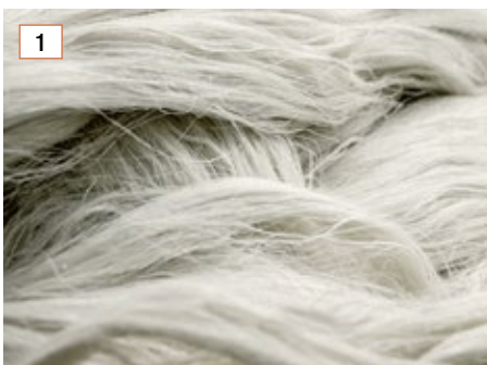
1: Ananasfasern sind der Grundstoff für ein neu entwickeltes Kunstleder, das etwa für Schuhe verwendet wird.
